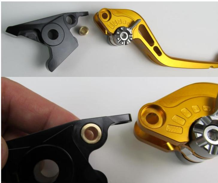
次はアタッチメントの組み付けになります。(E)のカラーをアタッチメントに装着します。カラーに薄くグリスを塗布してください。
