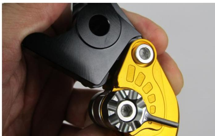
ナットを取り付けて強めに締め付けます。その際、アタッチメントを動かして動きが悪ければ少しナットを緩めてアタッチメントの動きを調整します。頻繁に動かす部分ではありません。少し動きが固いぐらいでガタが出ないように調整してください。
