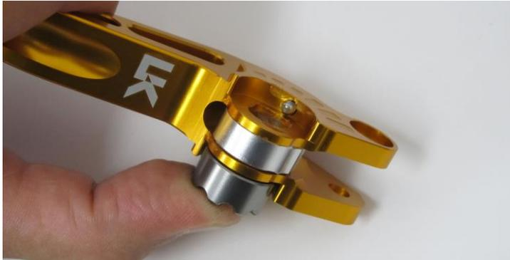
反対側に小スプリングと小ボールを取り付けてグリスを塗布します。
