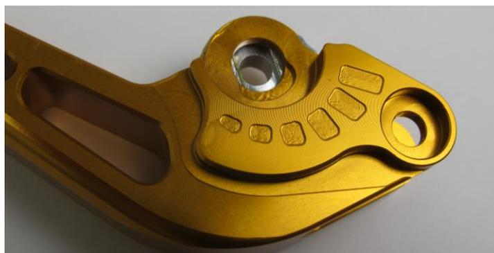
カム中央の長穴がレバーに対して垂直付近になるように組み付けます。
