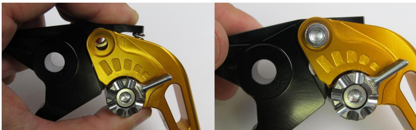
スプリングが両方の受け部にきれいにおさまると画像右のような状態になります。スプリングを押して(G)20mmボルトを装着します。
